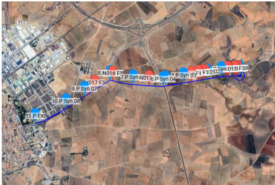
Tubería inspeccionada, incidentes detectados, sincronizadores, P INS y P EXT.
